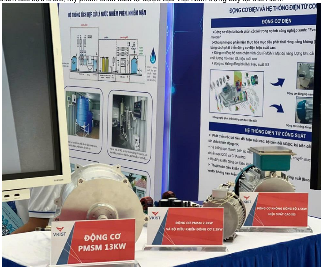
Trưng bày 3 động cơ gồm: Động cơ không đồng bộ 1.5kW hiệu suất cao IE3; Động cơ PMSM 13kW; Động cơ PMSM 2.2kW và bộ điều khiển động cơ 2.2KW.
