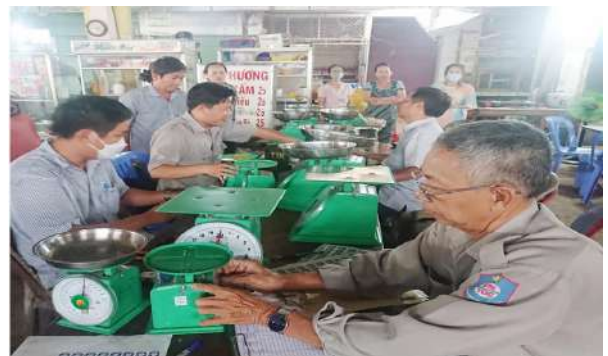
Kiểm định cân đồng hồ lò xo (cân cấp 4) tại chợ của Trung tâm Ứng dụng tiến bộ KH&CN AG
