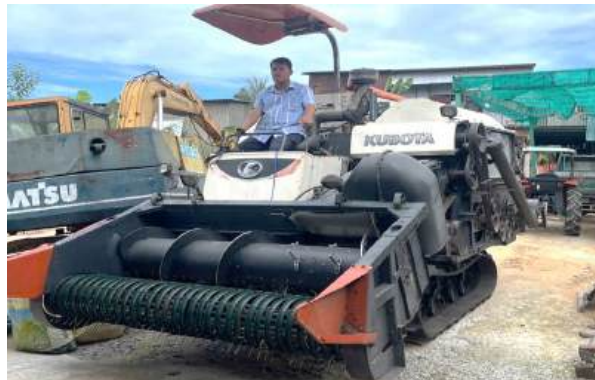
Anh Hai Lâm bên chiếc máy suốt rau muống cải tiến từ máy gặt đập liên hợp
