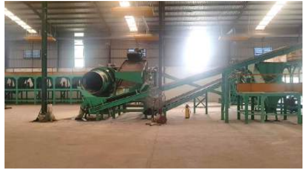
Dây chuyền phối trộn tự động vào quy trình sản xuất phân bón vô cơ của Công ty CP Hóa Nông An Giang
